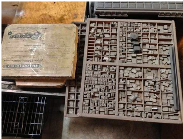
Prensa de la época para impresiones tipográficas. Caja con los tipos usados para el armado de la rama
